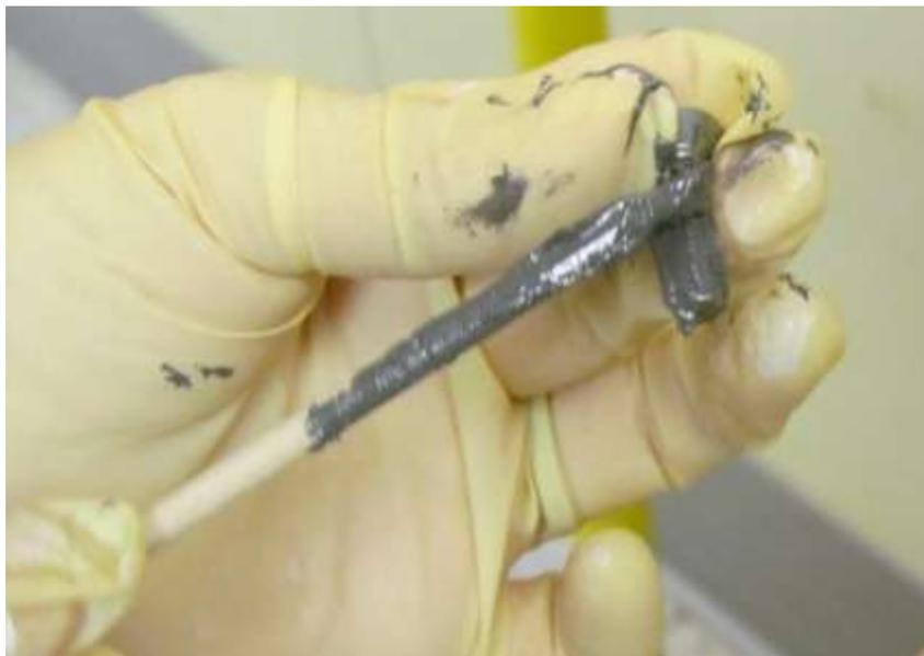
FIGURE 4.6.5 SEALANT BRUSHED ON TO FASTENERS
