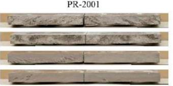
FIGURE 6.2.5 7075-T6 (HCF PRIMERS) TEST VEHICLE BUTT JOINTS AFTER 1008 HOURS OF EXPOSURE TO SO<sub>2</sub> SALT FOG
